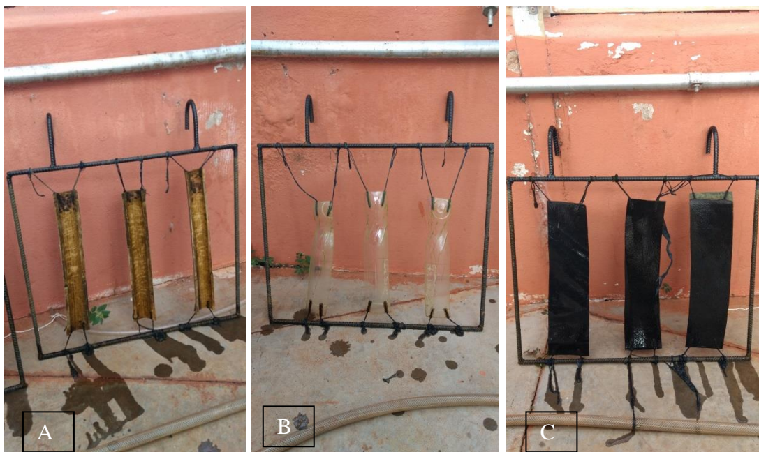
Figura 02. Estrutura contendo os substratos para crescimento do perifíton. a) substrato de bambu, b) substrato de garrafa PET e c) substrato de geomembrana.
